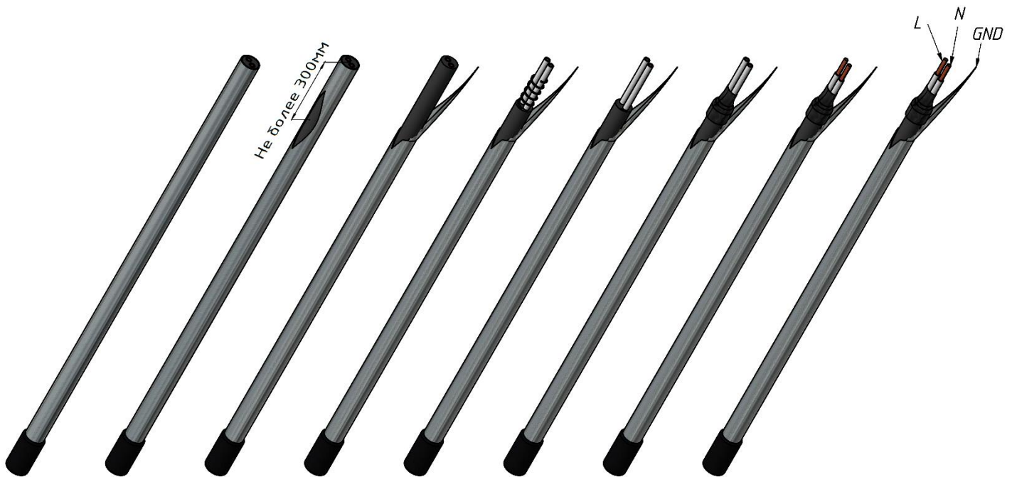
Рисунок 11. Подготовка отрезка ПЭНа к подключению
